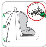
**ACHTUNG:** Wurde der Top Tether (TT) korrekt befestigt, erscheint am Sicherungsknopf eine grüne Markierung.
