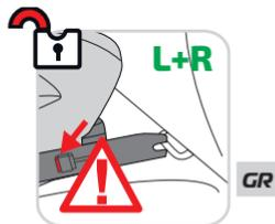
Στη συνέχεια πάρτε το top tether (TT) και οδηγήστε το κάτω από το προσκέφαλο του οχήματος στο κατάλληλο σημείο αγκύρωσης top tether του οχήματος. Αυτό μπορείτε να το βρείτε μέσω του εγχειριδίου οδηγιών του αυτοκινήτου σας.
