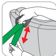
Jetzt können Sie die ISOFIX-Entriegelungstasten (**IT**) an den ISOFIX-Klemmen (**IK**) betätigen, um diese von den ISOFIX-Ankern (**IA**) zu lösen. Ziehen Sie den **HEYNER® MultiRelax AERO Fix** nach vorn um die beiden ISOFIX-Klemmen (**IK**) wieder in das Basisteil (**BT**) des Sitzes zu schieben.
