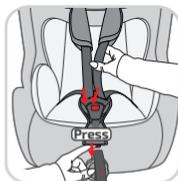
Теперь протяните поясную часть ремня безопасности (W), включая язычок замка ремня безопасности (V), над подлокотниками автокресла и вставьте язычок в замок. Вы услышите "щелчок", если замок закрыт.
