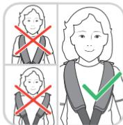
L'appui-tête peut être placé dans 10 positions différentes. Dans le groupe I, 5 hauteurs différentes peuvent être réglées. Lorsque la ceinture à 5 points est retirée, 5 positions supplémentaires sont disponibles. Vérifiez de temps en temps la hauteur de la ceinture et de l'appui-tête et réglez-les en fonction de la taille de l'enfant.
