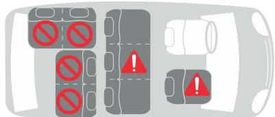
Pour le montage avec ISOFIX et Pied support, il existe une homologation „semi universelle“. Le siège ne peut donc être utilisé que dans certains véhicules. Veuillez vous référer à la liste des types de véhicules approuvés.
