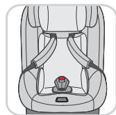
Ved å trekke på det sentrale justeringsbeltet (G5) sørge for at seletøyet berører barnet fast og ikke er vridd. Unngå tykke klær under beltet, spesielt om vinteren.
