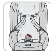
Joignez les deux languettes de verrouillage (C) des sangles de harnais (G2) ensemble et connectez-les avec la boucle (D) jusqu'à ce qu'un „clic“ clair se fasse entendre.
