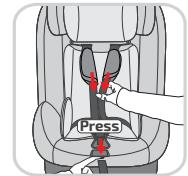
Uvoľnite ramenné pásy zatlačením nastavovania (GV) popruhu a potiahnutím trakových pásov (G2) k sebe.
