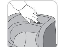
Nur eine optimal eingestellte Kopfstütze gewährleistet maximale Sicherheit. Die Kopfstütze sollte so eingestellt sein, dass das integrierte 5-Punkt-Gurtsystem (G) auf Schulterhöhe des Kindes verläuft.
