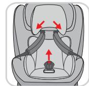
Saisissez sous la housse au bord inférieur du siège et tirez-la légèrement vers l'avant et vers le haut. Tirez la housse par-dessus la boucle de ceinture.
