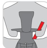
Теперь направьте поясной ремень (W) с язычком защелки (V) через красные направляющие ремня детского автокресла в трехточечный замок ремня и зафиксируйте язычок защелки (V) от трехточечного ремня автомобиля в трехточечном замке ремня с помощью звукового сигнала <<CLICK>>.
