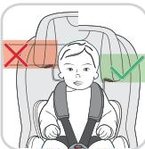
L'appui-tête doit être réglé de manière à ce que la distance entre les épaules de l'enfant et l'appui-tête ne dépasse pas environ 3 cm (environ 2 doigts de largeur).
