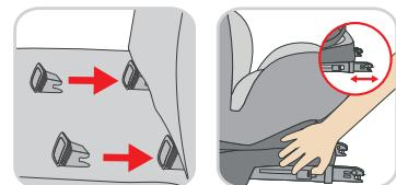
Veuillez vérifier avec les indicateurs de sécurité des DEUX CÔTÉS si le siège est correctement connecté aux deux ancrages ISOFIX (IA) de la voiture.
