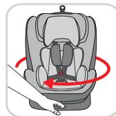
Pour pouvoir tourner le siège, vous devez presser le bouton pour tourner le siège et tourner le siège en même temps. Le siège s'enclenche avec un „click“ audible.
