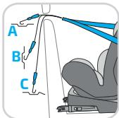
Prenez maintenant le crochet de fixation supérieure (TT) et guidez-le sous l'appuie-tête du véhicule jusqu'au point d'ancrage de fixation supérieure approprié du véhicule. Veuillez consulter le mode d'emploi de votre voiture. Accrochez le Top Tether et serrez la ceinture.
