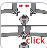
Joignez les deux languettes de verrouillage (C) des sangles de harnais (G2) ensemble et connectez-les avec la boucle (D) jusqu'à ce qu'un „clic“ clair se fasse entendre.
