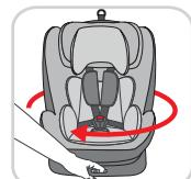
Чтобы привести в действие функцию вращения, необходимо нажать на кнопку фиксации и одновременно повернуть сиденье в нужное направление. Сиденье фиксируется отчетливым щелчком.
