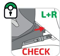
Опустите фиксатор на разъемах ISOFIX-Konnektoren с помощью одновременного нажатия кнопки разблокировки и вытягивания рычагов фиксации из петель ткани.
