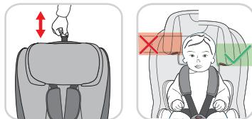
Регулировка системы ремней для ребенка производится при помощи перестановки высоты подголовника (A).
