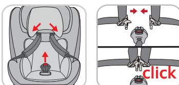
**VÝSTRAHA:** Dbajte na to, aby zámka pásu nebola znečistená. Len čistá zámka pásu zapadne zreteľne a bezpečne.
