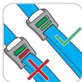
Περάστε τη ζώνη ασφαλείας της ζώνης ασφαλείας 3 σημείων του αυτοκινήτου πίσω από το κάλυμμα μέσω του οδηγού ζώνης του παιδικού καθίσματος αυτοκινήτου.
