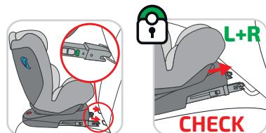
Len správne upevnenie OBIDVOCH KONEKTOROV (OK) zabezpečuje korektné upevnenie autosedačky a bezpečnosť Vášho dieťaťa vo vozidle!!!
