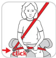
Infine se l'auto ne è dotata fissa la cintura all'ancoraggio (**D**). Questo serve affinché la cintura diagonale (**N**) rimanga posizionata sulla spalla del tuo bambino ottimizzando la guida della cintura. Fai passare la diagonale (**N**) attraverso l'ancoraggio (**D**) che trovi sullo schienale del sedile dell'auto all'altezza e subito dietro la spalla del tuo bambino. Il nastro dell'ancoraggio deve passare dietro la schiena del bambino.
