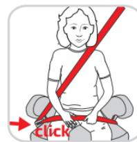
Beenden Sie das Anschnallen Ihres Kindes mit dem Anbringen des Gurtblockierers (**D**). Er dient dazu, den Diagonalgurt (**N**) fest an die Schulter des Kindes zu führen und den Gurtverlauf zu optimieren. Fädeln Sie den an der Rückseite des Sitzes befestigten Gurtblockierer (**D**) auf den Diagonalgurt (**N**) oberhalb der Schulter des Kindes auf.
