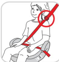
Finalizați fixarea copilului Dvs în scaunul auto, cu montarea clipsului (**D**) pe centura diagonală (**N**). Acesta va bloca centura diagonală (**N**) pe umerii copilului și va oferi o stabilitate majoră pe scaun. A se fixa clipsul mereu în parte de sus a centurii, la spatele copilului.
