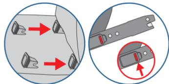
Les points de fixation ISOFIX sont situés entre le siège et le dossier du siège auto.
