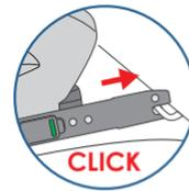
Пожалуйста, проверьте маркировку на BOTH PAGES, правильно ли кресло закреплено на двух креплениях ISOFIX (IA) автомобиля.
