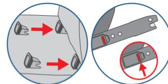
Bevor Sie den capsula® JR4X auf den Autositz platzieren, befestigen Sie bei Bedarf die zwei mitgelieferten Einbauhilfen (IH) an den ISOFIX-Ankern (IA) in Ihrem Auto.
