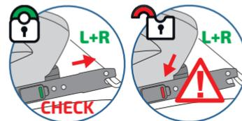
Seulement une fixation correcte LES DEUX CLAMPES garanties le support prévu du siège et la fixation de votre enfant dans le véhicule!
