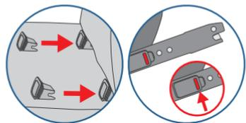
Πριν τοποθετήσετε το capsula® JR4X στο κάθισμα του αυτοκινήτου, στερεώστε, εάν χρειάζεται, στο όχημά σας τα δύο παρεχόμενα βοηθήματα τοποθέτησης (IH) στις υποδοχές ISOFIX (IA). Τα σημεία στερέωσης ISOFIX βρίσκονται μεταξύ της έδρας και της πλάτης του καθίσματος αυτοκινήτου.
