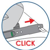
Überprüfen Sie vor dem Einbau die Sicherheitsindikatoren (IT). Diese müssen beide ROT sein. Sind die Sicherheitsindikatoren nicht ROT, ziehen Sie die Entriegelungstasten, bis sie ein deutliches »CLICK« hören.
