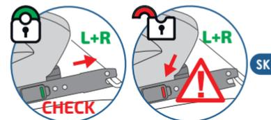
Len správne upevnenie OBIDVOCH KONEKTOROV zabezpečuje korektné upevnenie autosedačky a bezpečnosť Vášho dieťaťa vo vozidle.
