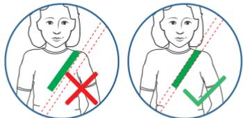
U niektorých vozidiel diagonálny pás neprechádza optimálne cez oblasť ramien vášho dieťaťa. Pri používaní ako posilňovacieho sedadla vždy skontrolujte, či je diagonálny pás v správnej polohe. Ak diagonálny pás nepracuje v určenom rozsahu, použite dodané pružné vedenie pásu.
