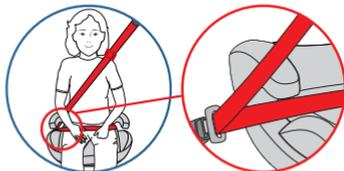
Most rögzítse a hárompontos biztonsági övet hallható »CLICK« hanggal (2. ábra). Győződjön meg arról, hogy az övszj mindkét oldalon a rögzítőfülek (C) alatt fut, és hogy az átlós öv csak az övcsat oldalán (Q) lévő rögzítőkarok (C) alatt vezet.
