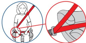
Diagonálny pás by sa mal rozprestierať stredom ramien, panvový pás by sa mal pokiaľ možno rozprestierať cez slabinovú ryhu.
