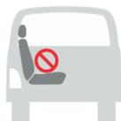
**HINWEIS:** Der Kindersitz muss, auch wenn er nicht benutzt wird, IMMER mit dem Fahrzeuggurt befestigt werden. Dies gilt auch, wenn der Sitz mit dem ISOFIX-System verbunden ist. Bei einer Notbremsung oder eines Aufpralls kann ein unbefestigter Sitz Sie oder andere Mitfahrer verletzen.
