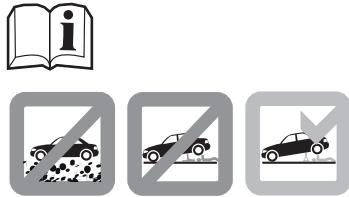
Подставки можно использовать только на горизонтальной и твердой поверхности.
