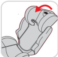
Соединительные кронштейны спинки должны войти в пазы подушки автокресла с заметным «щелчком». В результате спинка должна зафиксироваться в положении 90 градусов к подушке и не отклоняться. Если спинка не зафиксировалась, то автокресло не готово к эксплуатации. Пожалуйста, повторите процедуру сборки.
