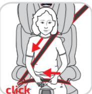
Zasuňte diagonálny pás do vodítka pásu (E) označeného červenou farbou na boku opierky hlavy (D) a napnite ho napnutý v smere mechanizmu navíjača. Diagonálny pás musí pevne priliehať k dieťaťu a nesmie sa krútiť.
