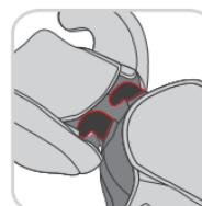
Placez le dossier à plat derrière la coque du siège. Insérez ensuite les deux crochets de liaison (A) de la partie inférieure du dossier par le haut dans les ouvertures (B) prévues dans la partie arrière de la coque du siège. Maintenant, redressez soigneusement le dossier (angle de 90 degrés) et laissez les deux crochets de connexion s'engager fermement.
