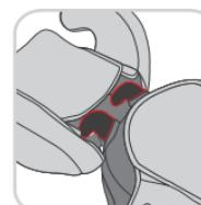
Amennyiben a háttámla és az ülésmagasító még nincsenek összeszerelve, úgy a következők szerint járjon el. Fektesse el teljesen laposan a háttámlát az ülésmagasító mögé. Illessze be minden összekötő akasztót (A) a háttámla alsó részén található erre a cérla tervezett nyílásokba (B) az ülésmagasítón. Lassan emelje meg a háttámlát (90-fokos szögig) és igazítsa be minden összekötőt a helyére.
