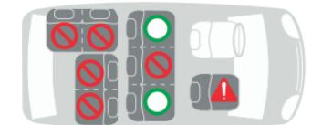
Na sedadlách vozidla obrátených dozadu napr. v dodávke alebo mikrobuse je použitie povolené za predpokladu, že sedadlo vozidla je schválené na prepravu dospelých osôb.
