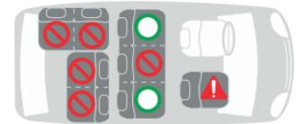
На сидениях автомобиля, установленных поперек или против хода движения автомобиля, использование детского автокресла запрещено. На задних сиденьях транспортных средств, таких как Van или микроавтобус, использование разрешается, если эти сиденья транспортного средства допущены для перевозки пассажиров.
