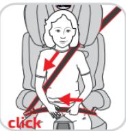
Зафиксируйте ребенка с помощью BFit диагональный ремень в направляющей ремня (E), отмеченной красным цветом на боковой стороне подголовника (D) и натяните его в направлении втягивателя. Диагональный ремень должен плотно прилегать к ребенку и не должен быть перекручен. Угловой ремень и диагональный ремень трехточечного ремня и закрыть его четким „щелчком“.
