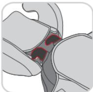
Operadlo v zvislej polohe musí pevne dosadať na podsedák a po ukončení montáže sa nesmie prevrátiť dozadu.
